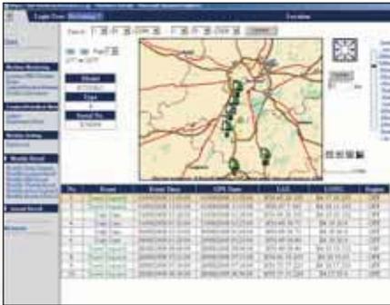
**Слежение за состоянием машины во время транспортировки** - В случае транспортировки машины система KOMTRAX™ сообщает о ее текущем положении по электронной почте или в виде сообщений, отправленных на веб-сайт, и подтверждает факт ее прибытия в пункт назначения.
