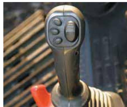
Джойстик с кнопками пропорционального управления навесным оборудованием
