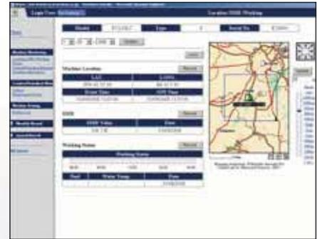
**Повышенный уровень безопасности** – Функция «блокировка двигателя» позволяет задавать момент запуска двигателя машины. А используя функцию «область наблюдения», система KOMTRAX™ посылает уведомление каждый раз, когда ваша машина с той или другой стороны пересекает установленные границы рабочей зоны.
