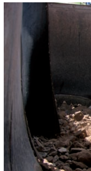
Листовой материал компании Sandvik легко режется и подгоняется к сложным поверхностям.
