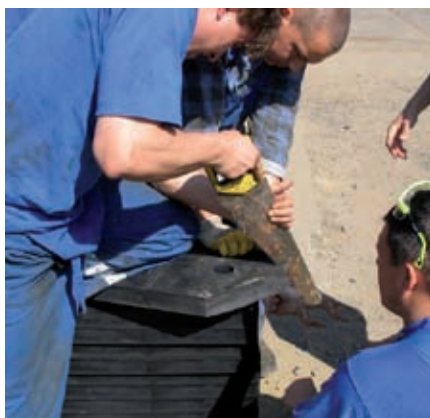
Модульные износостойкие плиты Sandvik WT7000, изготовленные из резины двойной твердости, можно легко резать по месту с помощью ножовки.
